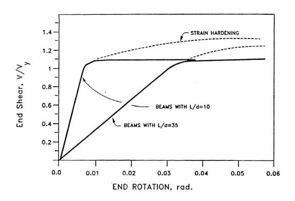
FIGURE 2-5: SHEAR-ROTATION CURVES OF TYPICAL BEAMS
